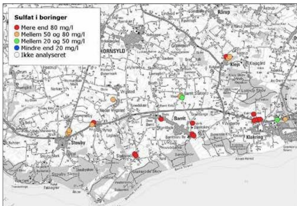
Figur 8.12. Sulfatindholdet i borerne. Mange borer har et forhøjet indhold af sulfat.
