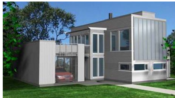
Eksempel på solvæg på husets facade. En solvæg kan både forvarme ventilationsluft og bidrage med varme til bygningen.
